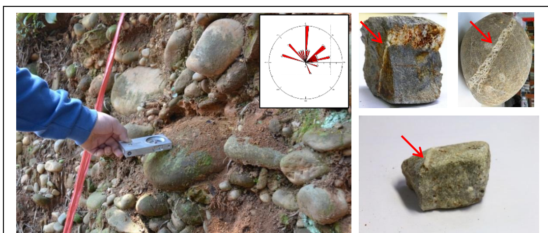
圖 18 礫石覆瓦構造方向量測、古水流方向玫瑰圖與含石英脈的變質砂岩（紅色箭頭所指為石英脈）（郭勝煒，2017）
