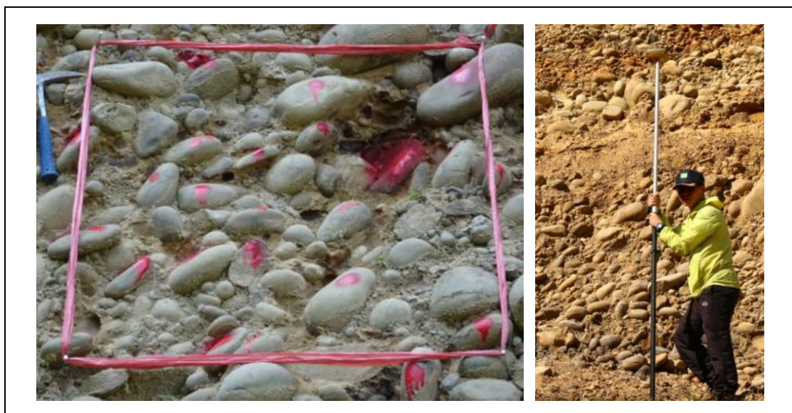
圖 17 礫石覆瓦構造方向量測與露頭高程定位及量測（郭勝煒，2017）
