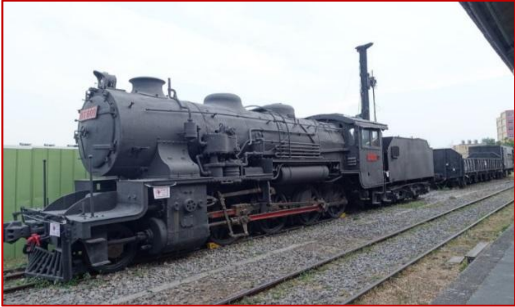
圖 5 車籍 DT609 的蒸氣火車，是 1929 年日本設計製造的，主要是用來載貨，台灣原本有 39 輛，在 1982 年報廢後，這是唯一被保存下來的一輛。載貨的輪胎數和載客的不同，前者較多。 (謝杏子攝)
